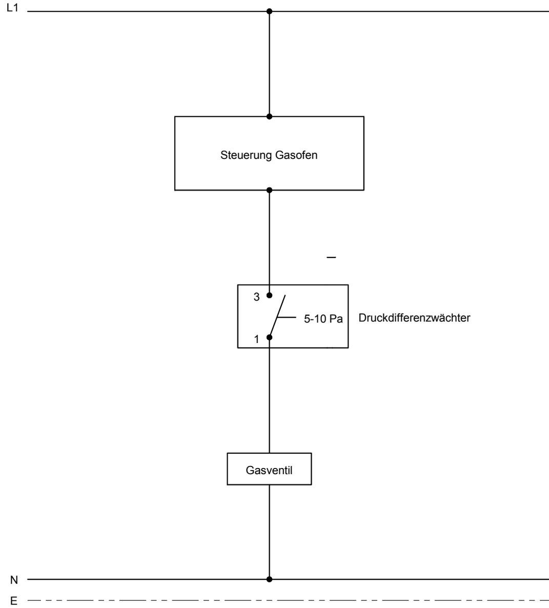
Schema Strömungsüberwachung für Gasheizungen
