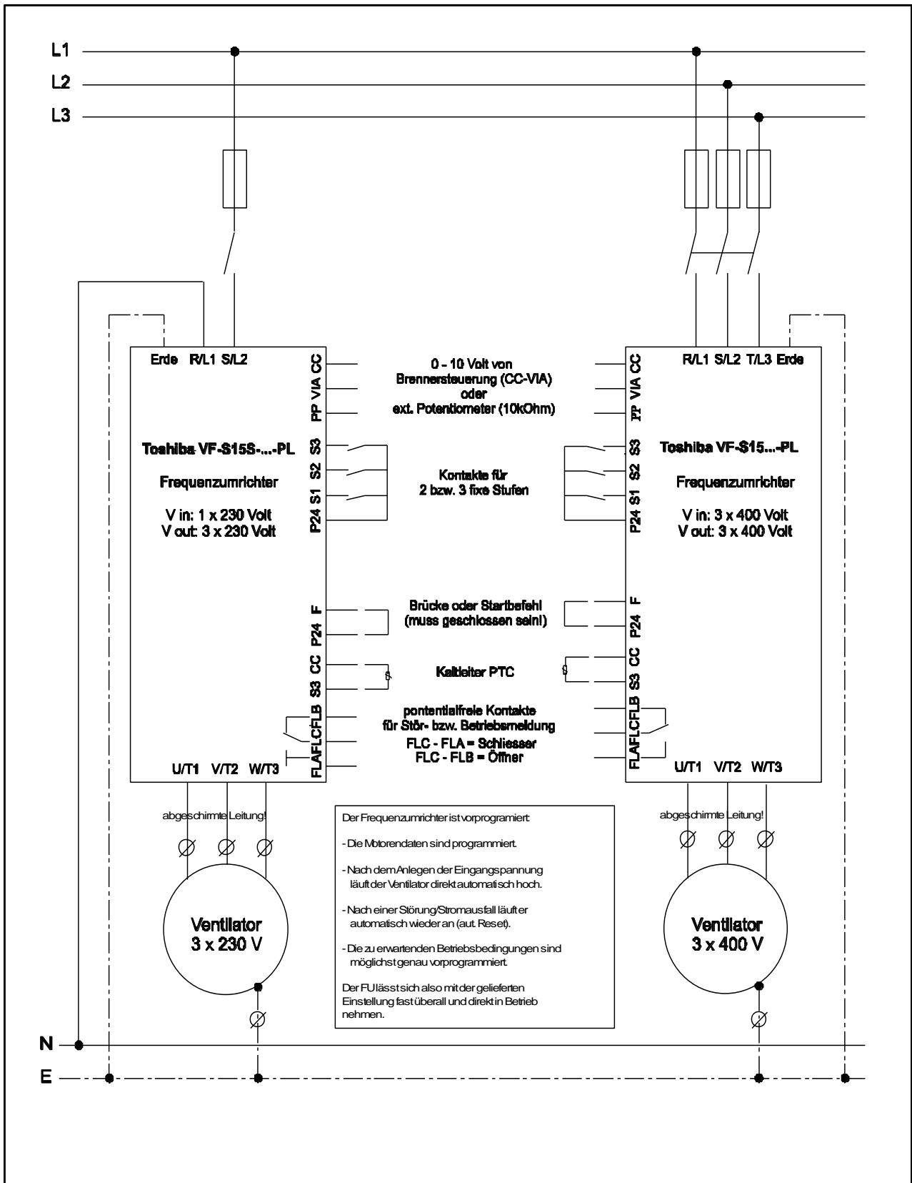
Schema Oel-/Gasfeuerung - modulierend/2-3-stufig
